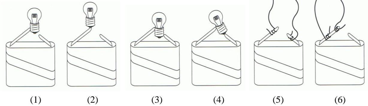
Ordne die Bauteile richtig zu und kennzeichne den Weg des elektrischen Stroms!
