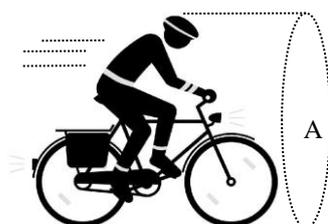
Je größer die Angriffsfläche  $A$  ist, umso mehr Luft muss verdrängt werden und umso größer ist die Luftwiderstandskraft  $F_L$ .
