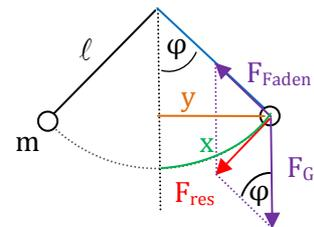
Die Schwingungsdauer  $T$  eines Fadenpendels hängt also nur von der Länge  $\ell$  des Fadenpendels und von der Erdbeschleunigung  $g$  ab.
