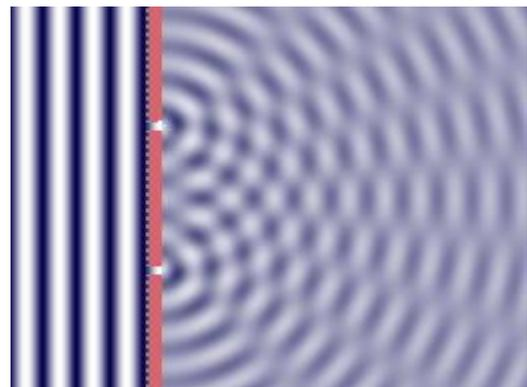
Ob an einem Punkt  $P$  konstruktive oder destruktive Interferenz auftritt, hängt beim Doppelspalt nur vom Abstand dieses Punktes von den beiden Spalten ab.
